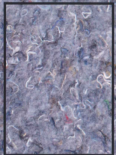
La matière utilisée pour l'isolation des façades est fabriquée à base de tissus recyclés.
